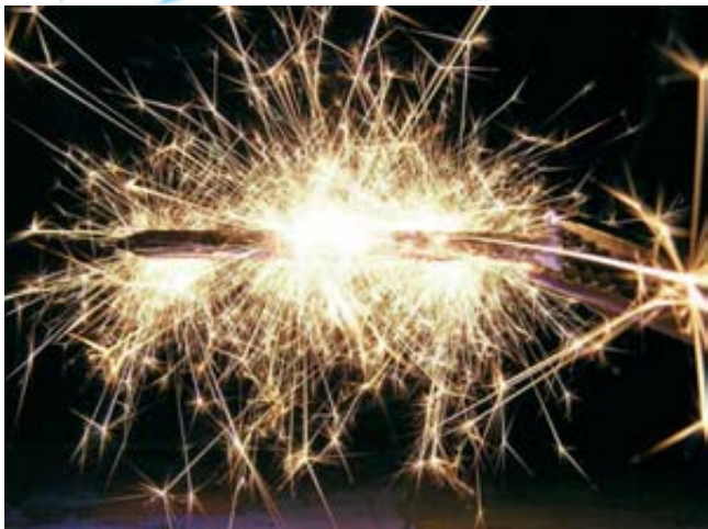
Cortocircuito provocado con una corriente de 12 V y 20 A
