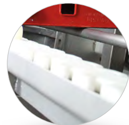
Cadena sintética para el transporte de cajas
