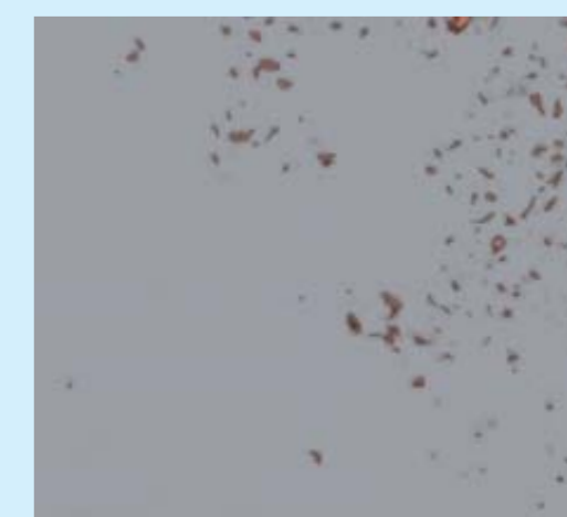
Imagen del biofilm tras el aclarado de la superficie utilizando agua a presión de red (3b) durante 6 s.
