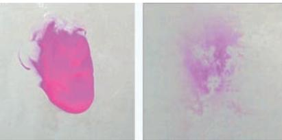
Figura 3: La aplicación y posterior aclarado del producto TBF 300 en una superficie de acero revela la presencia del biofilm por medio de una coloración permanente y detectable a simple vista
